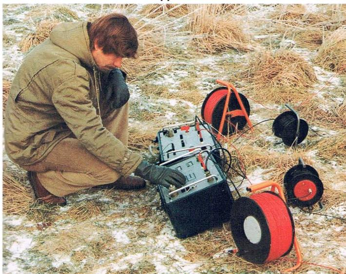
**Geoelektrische Widerstandsmessungen** sind ein unentbehrliches Hilfsmittel bei der Untersuchung oberflächennaher Schichten. Die Kernstücke der Anwendungsbereiche sind:
