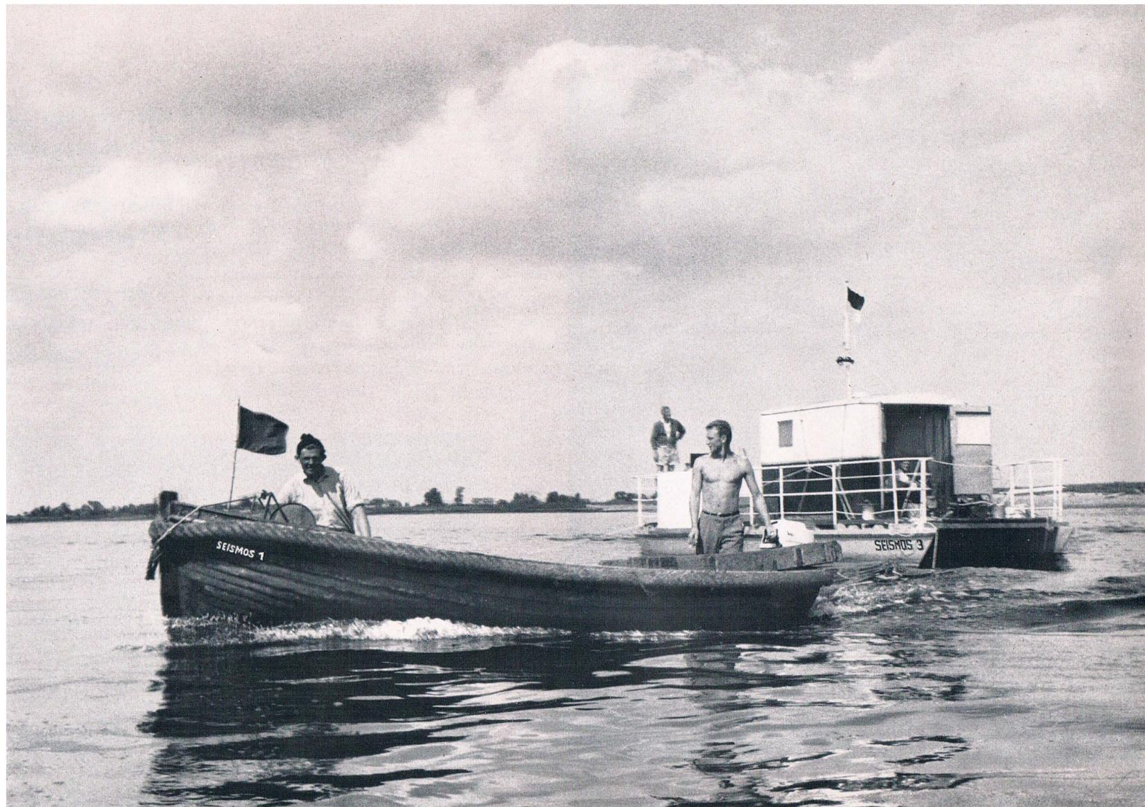
Flachwassermessungen mit der volltransistorisierten, tragbaren Reflexionsapparatur der SEISMOS; im Vordergrund das Schießboot, dahinter das Meßboot.
