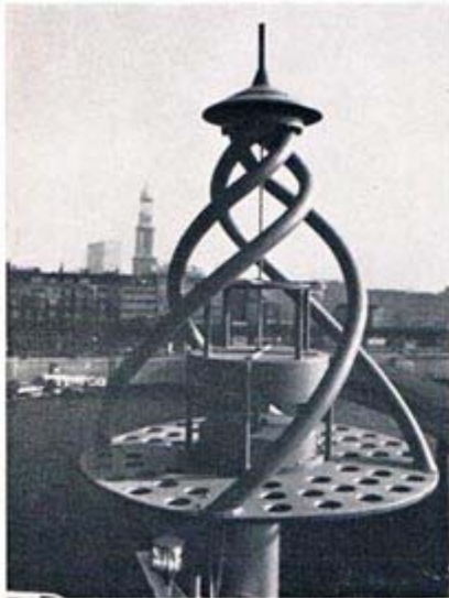
Antenne für die Navigationssatelliten.
