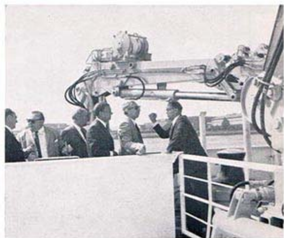
Ladekran für das Aussetzen der Luftpulsbatterien.
