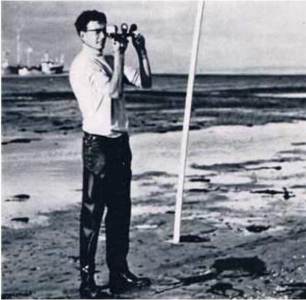
Einmessung mit Sextant und Meßstangen (Bild 5)
