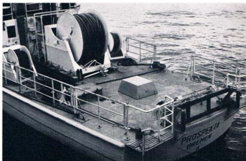
Achterdeck mit Trommeln für Meß- und Schußkabel
