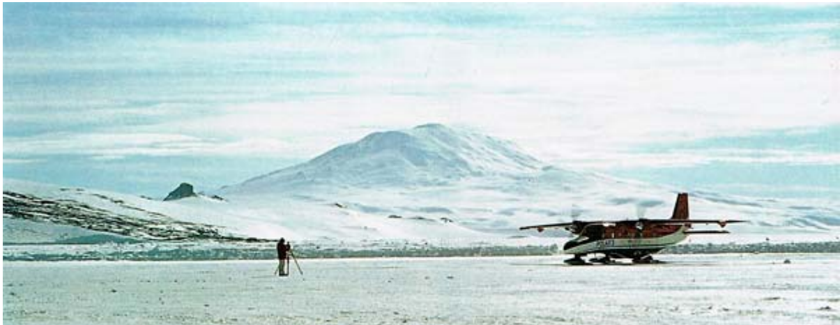
Kontrolle des Kreiselkompasses mit einem Bussolentheodoliten bei laufenden Motoren
