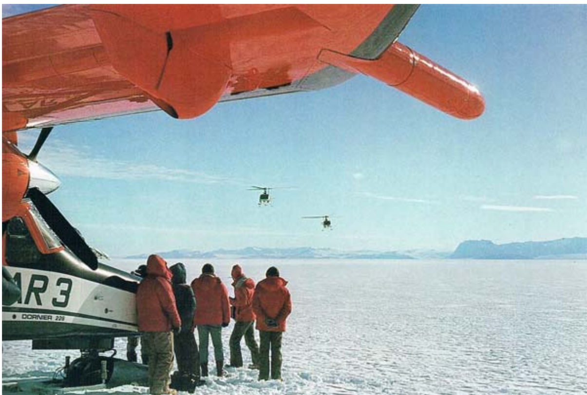
Der Landeplatz 'Browning-Paß' mit Blick zur Eisenhower-Range jenseits des Priestley-Gletschers. Im Sensorträger (rechts oben) ist das Magnetometer untergebracht. Personal und Fracht werden von den Hubschraubern zur 10 km entfernten GONDWANA-Station geflogen.
