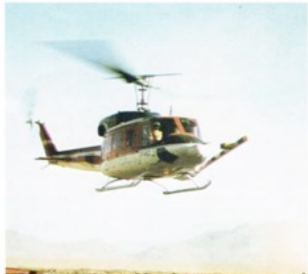
Bell-212-Hubschrauber für Gammastrahlen- und magnetische Messungen Bell-212 helicopter for gamma ray and magnetic surveys
