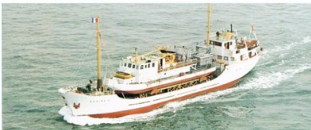
Flachwassermeßschiff, von seinem Mutterschiff 'huckepack' ins Meßgebiet gebracht Shallow-water survey vessel carried 'piggy- back' to the survey area by her mother ship
