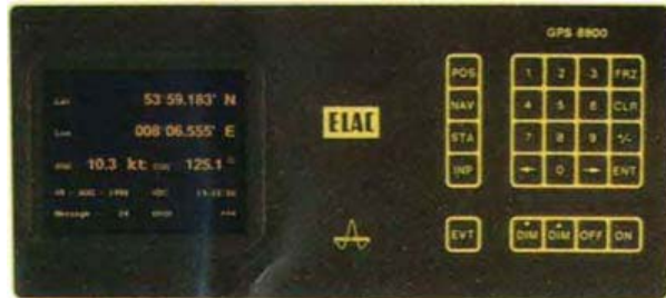
Das Gesicht des Empfängers GPS 8800 Front panel of the GPS 8800 receiver
