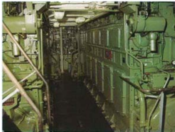
Herz des Schiffes sind die beiden MaK-Dieselmotoren (6 M 551 AK), die über Kupplungen und Untersetzungsgetriebe auf einen Escher-Wyss-Verstellpropeller wirken. Die Doppelanlage besitzt 4800 PS und gibt dem Schiff eine Geschwindigkeit von 15,5 Knoten.
