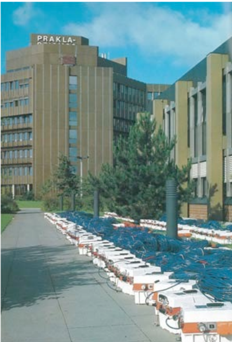
Remote units und Fiberoptik-Telemetriekabel. 'Zubehör' einer einzigen seismischen MDS-J6-Apparatur
