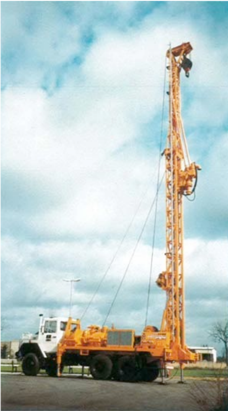
Schweres Brunnenbohrgerät RB 50, gebaut von PRAKLA-SEISMOS GEOMECHANIK
