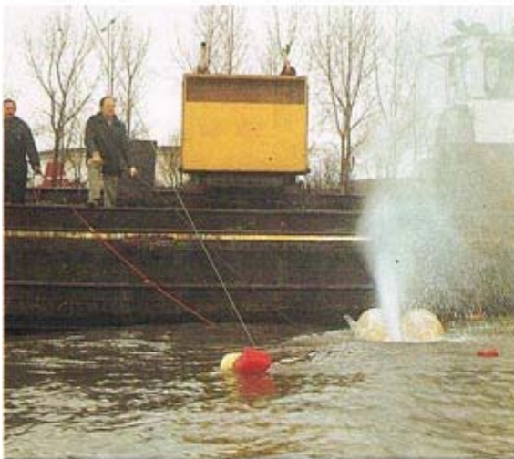
... und der Schuß über ein ZXDD auf der Brücke des Schiffes ausgelöst. Zur Verbesserung der Energieausbeute empfiehlt sich eine vertikale 4- bis 6fach-Stapelung.
