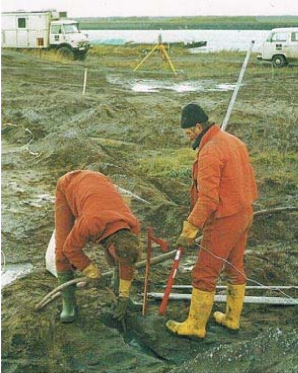
An geeigneten Stellen wird die Ladung eingespült If possible the holes are flushed for the charges
