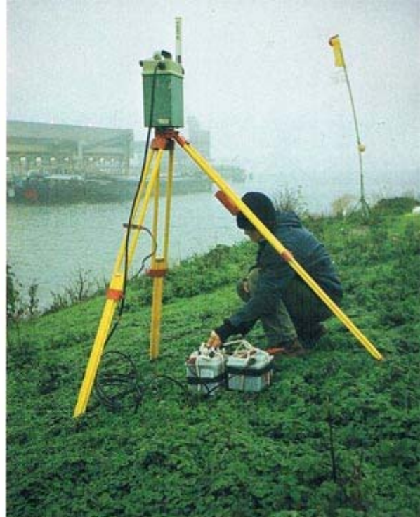
Eine TRISPONDER-Anlage wird in Betrieb gesetzt TRISPONDER equipment being put into operation
