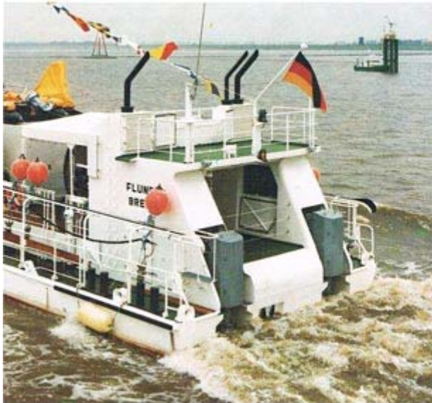
Schottel-Antrieb und Auslaßöffnung für den Streamer Schottel drive and outlet for the streamer
