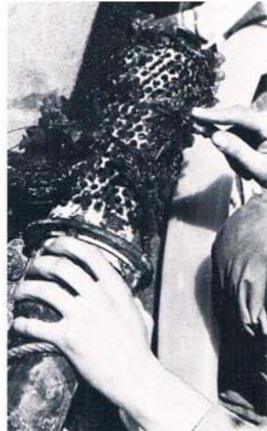
*Ein Fischernetz wird aus der Schraube entfernt...*
