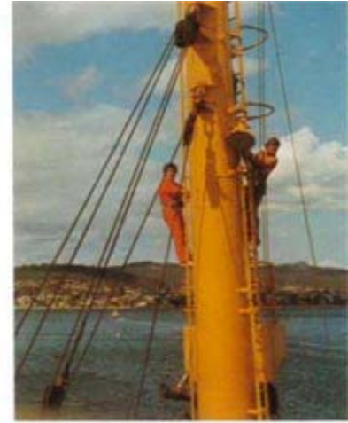
Die Eisscheinwerfer werden installiert Ice search-lights being installed
