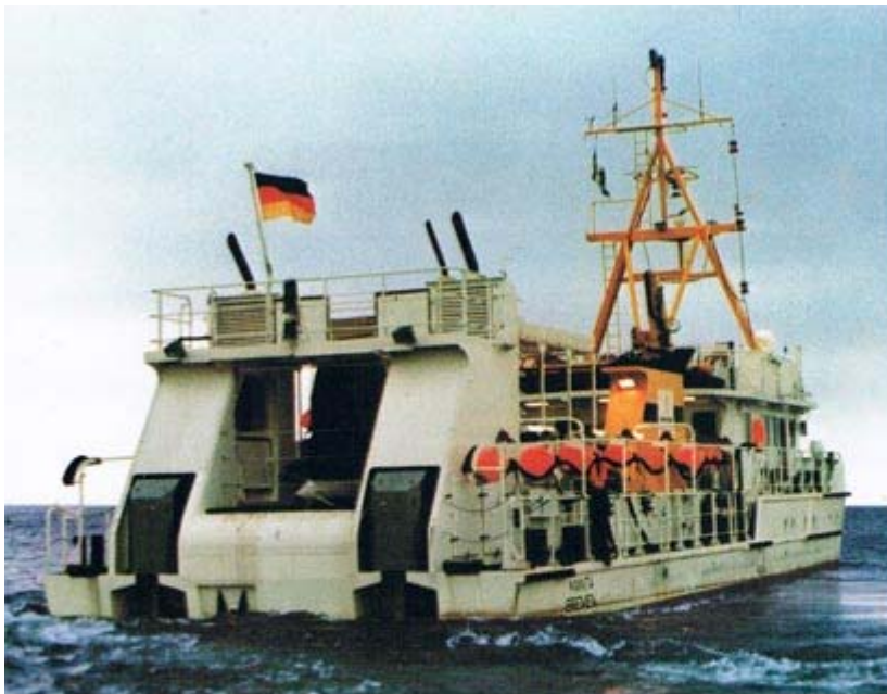
◀ Die Heckpartie – endlich ein richtiges Streamer-Arbeitsdeck! The stern – at last a proper streamer work-deck!
