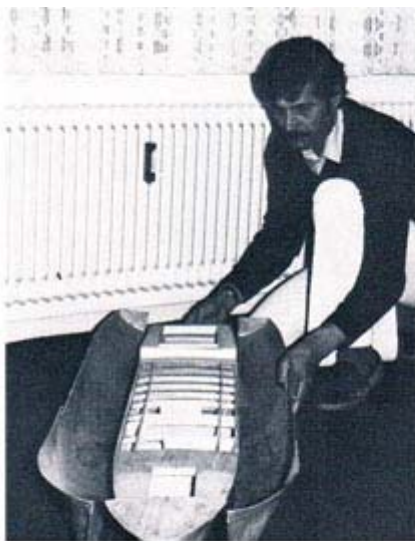
Die beiden Kunststoffschalen, aus denen der Schiffsrumpf zusammengefügt wird, demonstriert vom Erbauer
