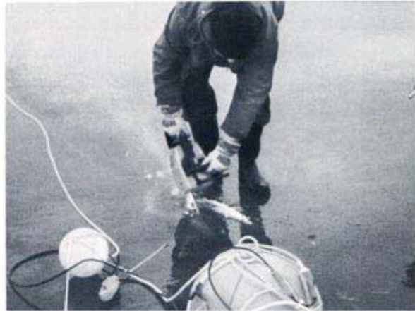
Zur Einbringung von Hydrophonen bw. Geophonen werden mit Baumsägen Löcher in das Eis geschnitten For lowering hydrophones or geophones into the water, holes are cut into the ice by chain-saws
