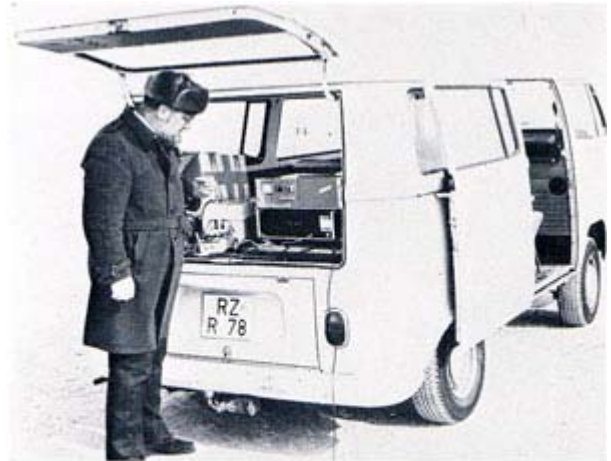
Reichweitentest für das NAREF-Bojen-Signal an der nordfriesischen Küste durch F. Sender Range test for the NAREF buoy signal along the North Frisian coast by F. Sender
